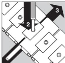
Con la herramienta adjunta, presione hacia abajo el perno de fijación (2) y meta simultáneamente el perno de articulación hasta que quede a ras de la pulsera (3).
