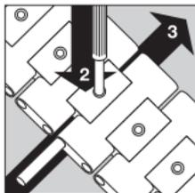
Ora con l'utensile allegato spinga in dentro il perno di fissaggio (2) e completi contemporaneamente l'inserimento nel bracciale del perno di snodo riportandolo a livello (3).
