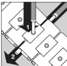
Abra el cierre apretando el pulsador lateral. Coloque la pulsera con su parte superior sobre una base firme. Con la herramienta adjunta, presione hacia abajo el perno de fijación en el punto de separación (1) deseado y empuje, con la segunda herramienta, el perno de articulación hasta que sobresalga unos 3 mm (2).
