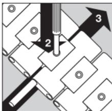
Mit dem beiliegenden Hilfswerkzeug drücken Sie nun den Fixierbolzen (2) hinunter und schieben gleichzeitig den Gelenkbolzen wieder bündig ins Armband zurück (3). Der Fixierbolzen muss wieder
