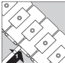
Junte las partes de la pulsera en el punto de unión y meta lateralmente el perno de articulación (1).
