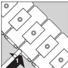
Fügen Sie die Bandgliedteile an der Verbindungsstelle zusammen und schieben Sie den Gelenkbolzen seitlich in das Armband ein (1).
