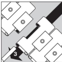
Ziehen Sie den vorstehenden Gelenkbolzen aus dem Armband (3). Jetzt ist das Metallband getrennt, und Sie können durch Wegnehmen oder Hinzufügen einzelner Glieder die Armbandlänge einstellen.
