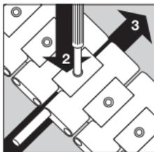
A l'aide de l'instrument fourni avec votre montre, enfoncez maintenant la cheville de fixation (2) tout en ramenant simultanément l'axe d'articulation de nouveau dans le bracelet (3). La cheville de fixation
