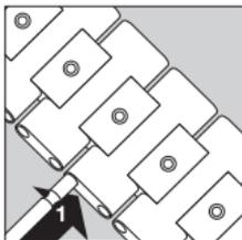
Ricongiunga le maglie terminali delle sezioni staccate del bracciale e le fissi inserendo lateralmente nel punto di giunzione il perno di snodo (1).
