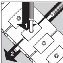
Öffnen Sie den Tastenverschluss durch Drücken der seitlichen Taste. Legen Sie das Band mit der Oberseite auf eine feste Unterlage. Mit den beiliegenden Hilfswerkzeugen können Sie nun an der gewünschten Trennstelle den Fixierbolzen hinunterdrücken (1) und dabei den Gelenkbolzen mit dem zweiten Hilfswerkzeug seitlich etwa 3 mm hinauschieben (2).
