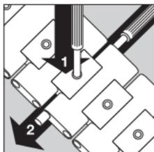
Apra la chiusura a tasto facendo pressione sul tasto laterale. Distenda il bracciale con il lato superiore appoggiato su un supporto rigido. Utilizzando gli utensili allegati, può ora spingere in basso il perno di fissaggio nel punto di separazione desiderato (1), e col secondo utensile spingere in fuori lateralmente di circa 3 mm il perno di snodo (2).
